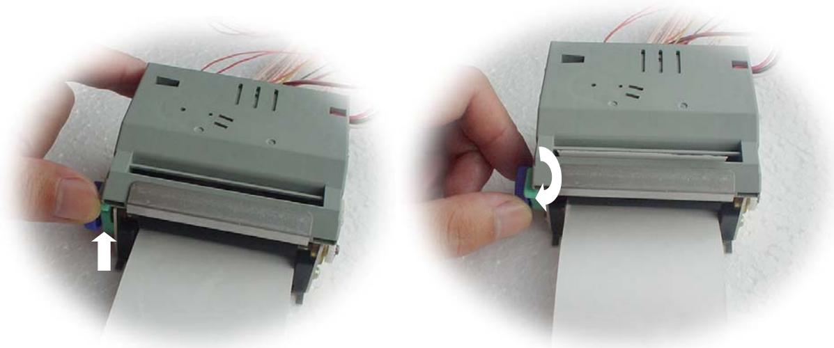
**注意：**保持纸张平整，纸张的出纸方向应与出纸口垂直，不能偏斜，否则将造成纸走偏或塞纸。
